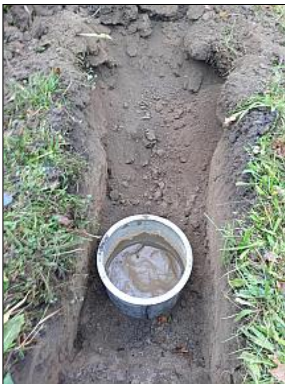
Vsakovací zkouška na vsakovací sondě VS-2
