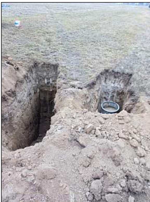
Vsakovací zkouška na vsakovací sondě VS-1
