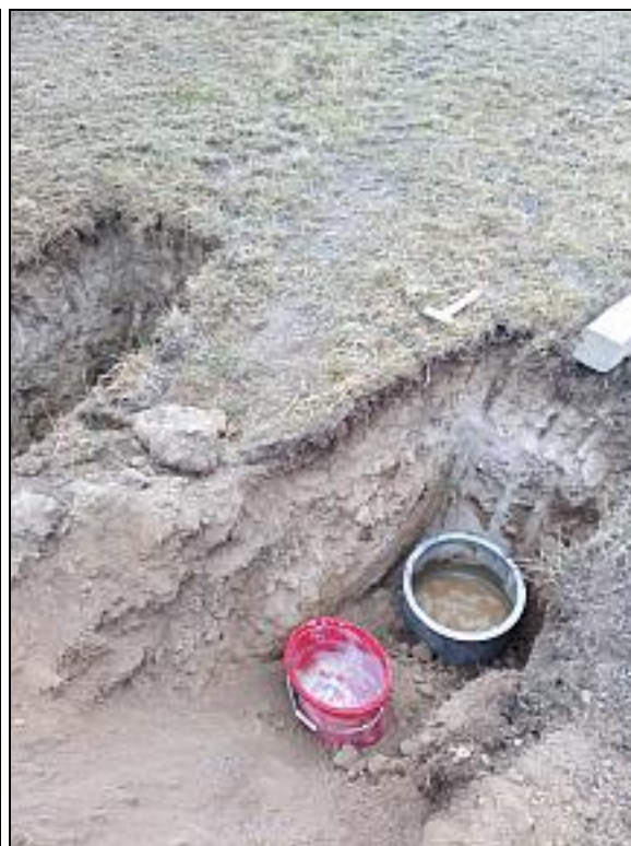
Vsakovací zkouška na vsakovací sondě VS-1
